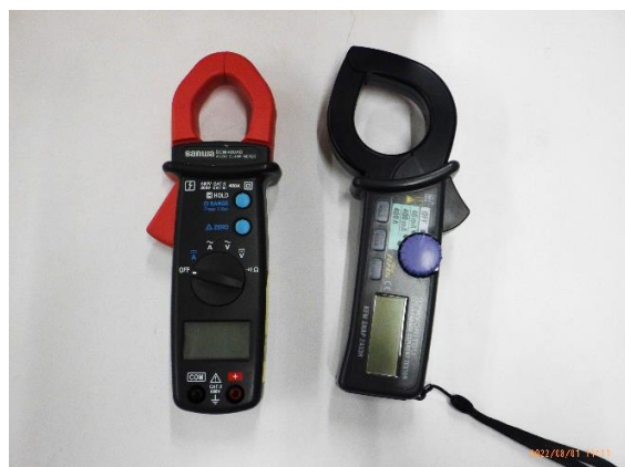
クランプメーター (電流の測定に使用)
