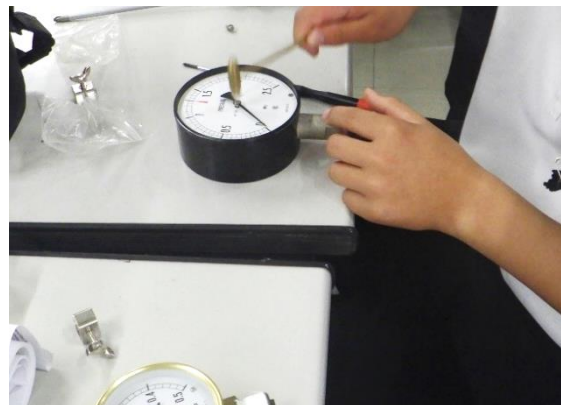
圧力計の整備
