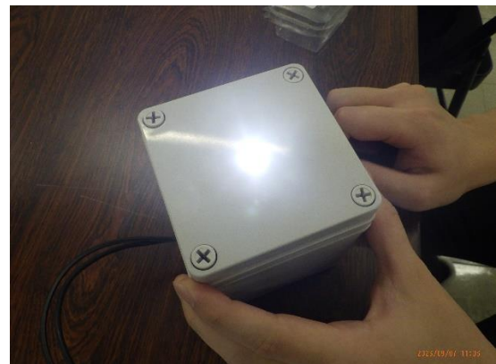
整流回路を用いた LED ボックス
